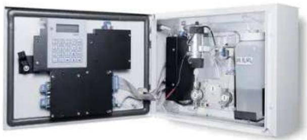
Анализатор АР-1 предназначен для непрерывного автоматического контроля содержания взвешенных частиц и нефтепродуктов в пробах воды (измерение мутности) и для контроля цвета воды. Анализатор осуществляет автоматический мониторинг потока воды для технологических процессов водоподготовки, энергетики, мониторинга состояния окружающей среды.
