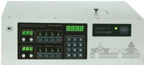
«ФЛЮОРАТ®-02-ПАНОРАМА» - классический исследовательский спектрофлуориметр. Для прибора разработана гамма приставок, позволяющих проводить измерения вне кюветного отделения прибора. Вместе с тем прибор аттестован как анализатор «Флюорат-02», что позволяет проводить измерения массовой концентрации веществ в соответствии с утвержденными методиками. Имеется
