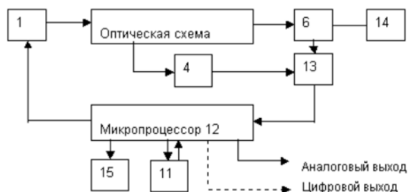
Рис.2. Функциональная схема сигнализатора
