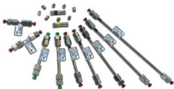
Компания «ЛЮМЭКС» предлагает **хроматографические колонки** для аналитической высокоэффективной жидкостной хроматографии и предколонки катриджного типа.
