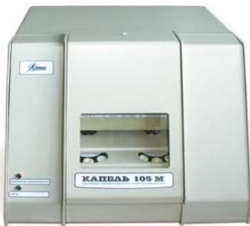
Главной отличительной особенностью модели «КАПЕЛЬ®-105М» является спектрофотометрическое детектирование.
