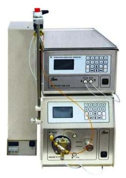
Жидкостный хроматограф «ЛЮМАХРОМ®» со спектрофотометрическим / флуориметрическим / спектрофлуориметрическим детектированием предназначен для качественного и количественного определения органических веществ в сложных пробах методом высокоэффективной жидкостной хроматографии.
