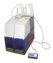
СВЧ-минерализатор «МИНОТАВР®-2» — единственный в России серийный прибор минерализации проб сложного состава под воздействием фокусированного микроволнового поля.
