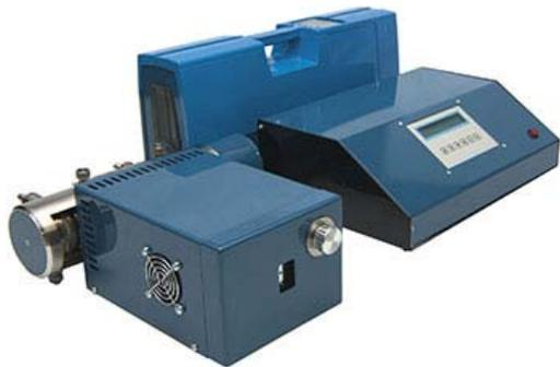
Двухсекционный атомизатор «ПИРО-915+» состоит из испарителя, в котором происходит испарение жидких и пиролиз твердых проб, и нагретого реактора, в котором происходит каталитическая деструкция соединений матрицы пробы. После пиролизатора газовый поток сразу поступает в аналитическую кювету, нагретую до 700 °С. Блок питания приставки обеспечивает постоянство скорости прокачки воздуха и температуры испарителя, реактора и кюветы.
