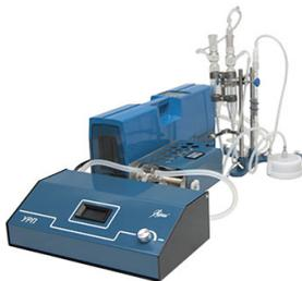
Приставка «РП-92» предназначена для перевода связанной ртути, находящейся в жидкой пробе в ионной форме, в атомарное состояние методом «холодного пара».
