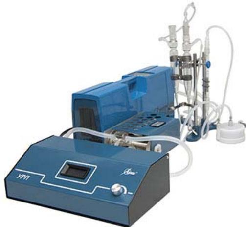
Приставка «УРП» работает в двух режимах – режиме измерений методом «холодного пара» и методом пиролиза. В первом режиме принцип действия и область применения приставки «УРП» полностью совпадают с характеристиками приставки «РП-92». В режиме пиролиза происходит термическая деструкция пробы и атомизация ртути, затем определение количества выделившейся ртути с помощью анализатора «РА-915М».
